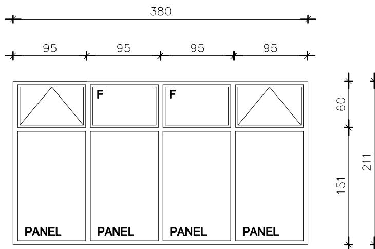
**Napomena:** koeficijent vodljivosti U cijele stijenke može biti najviše 1,4W/(m<sup>2</sup>K), staklo mora biti dvostruko, izolirajuće, 4 + 16 + 4 low e premaz, punjeno 90% argonom.
